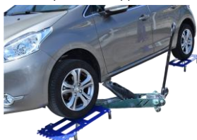
Mise en place de l'appui au cric
